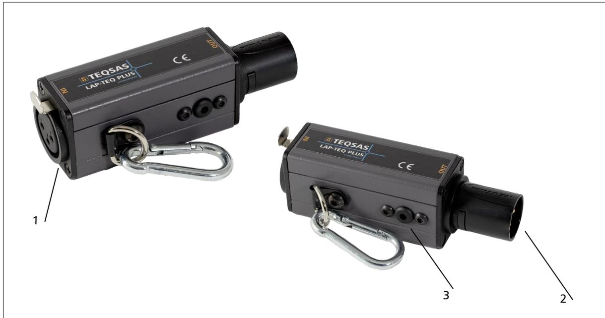
1. LAP-TEQ Port für weitere Sensoren im Daisy-Chain-Betrieb
